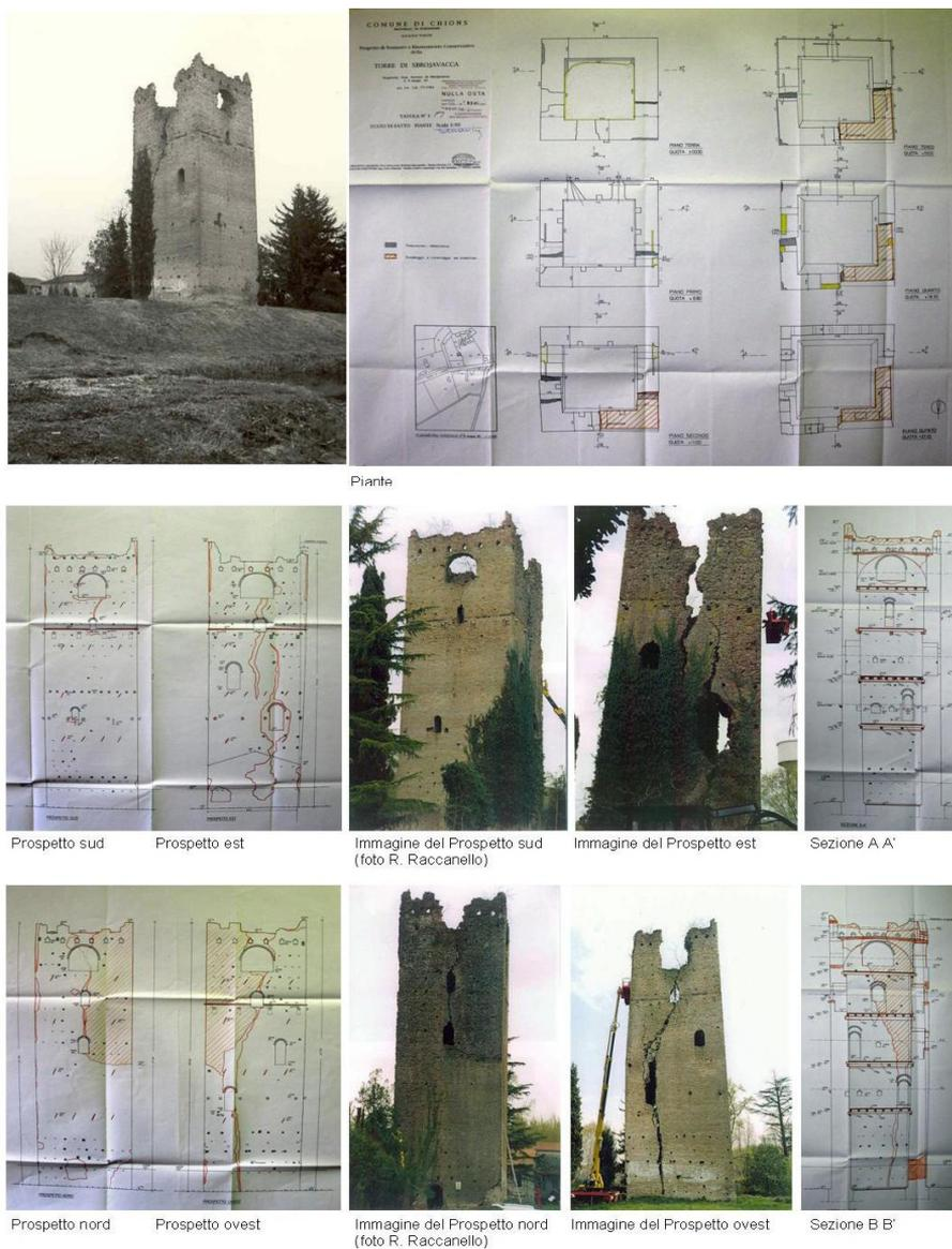
Fig 8.25 Tavole di rilievo-progetto e alcune foto dei prospetti.
