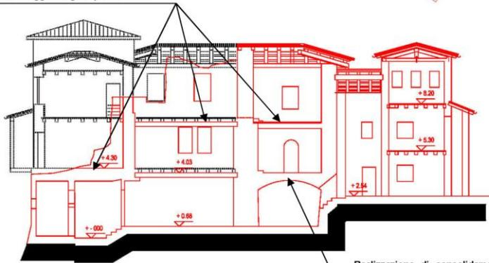
Realizzazione di consolidamento della strutture orizzontali a mezzo di cappa collaborante in cemento armato stesa sull'estradosso delle superfici voltate dei piani seminterrati, cappa ancorata a mezzo di spezzoni di ferro sulle stesse volte.
