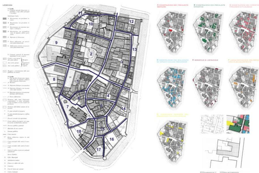
Fig.2.43 Piano Ballardini per la ricostruzione del centro storico di Venzone con indicate le varie categorie di progetto ed un dettaglio relativo ad una porzione
