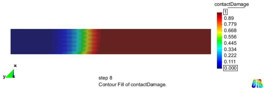
Fig. 56 Mappa di danneggiamento dell'interfaccia
