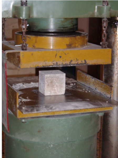
Fig. 77 Prova a compressione prismi in cls
