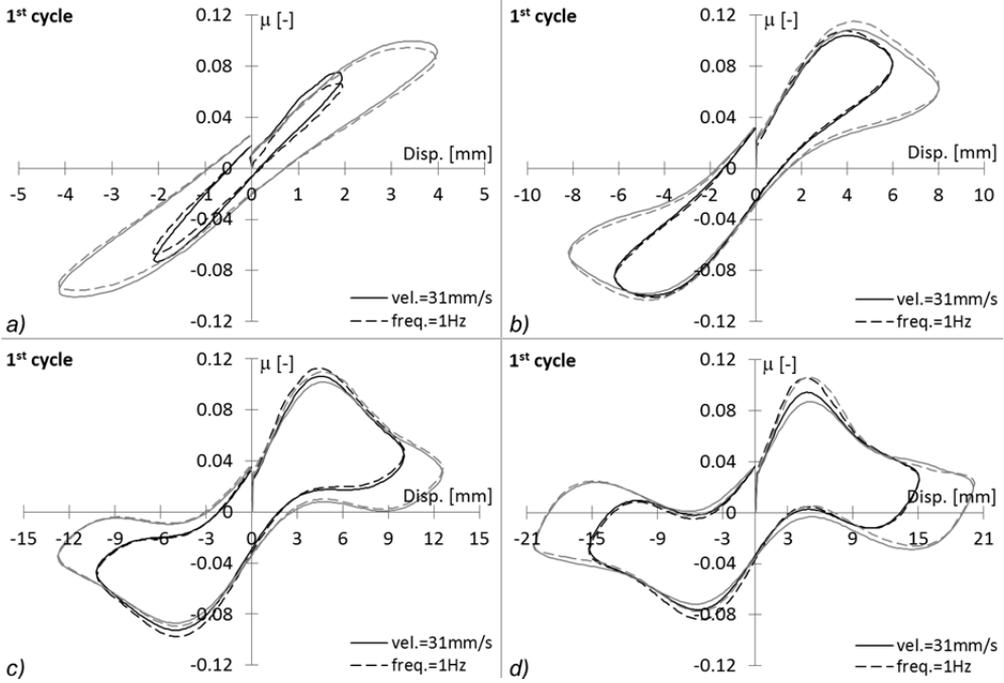
Fig. 6.14 Comparisons of  $\mu$ -disp loops-1<sup>st</sup> cycle. Rubber A-,  $t=2\text{mm}$ ,  $D=25\text{mm}$ ,  $W/ER^2=1.2$ .
