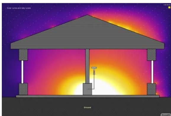
Figura 3.17: Immagine della simulazione condotta con *energy2d* per investigare il ciclo diurno di riscaldamento di una casa e il suo rapporto con il termostato.
