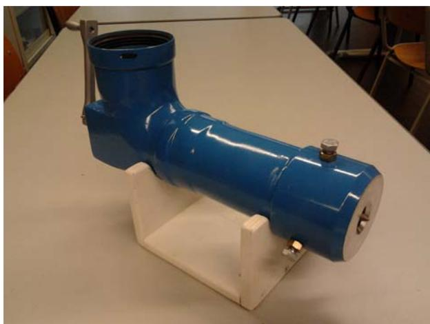
Figura 5.2: Fotografia dell'ago doble realizzato per il progetto.
