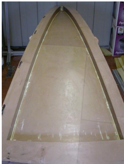
Figura 2.7 Stampo per la realizzazione di un settore parabolico, corrispondente ad 1/24 del paraboloide intero.
