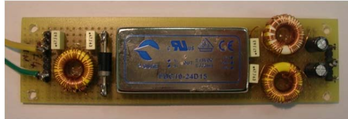
Figura 2 – Convertitore DC/DC per alimentare i circuiti di condizionamento.
