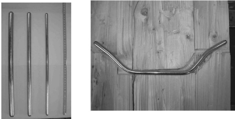
Fig. 2.15 Connessioni realizzate mediante l'utilizzo di spinotti: i connettori integri e dopo la prova
