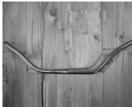
Fig. 2.5 Connessione legno - legno per prova push out durante il test e dopo il test (campione sezionato)
