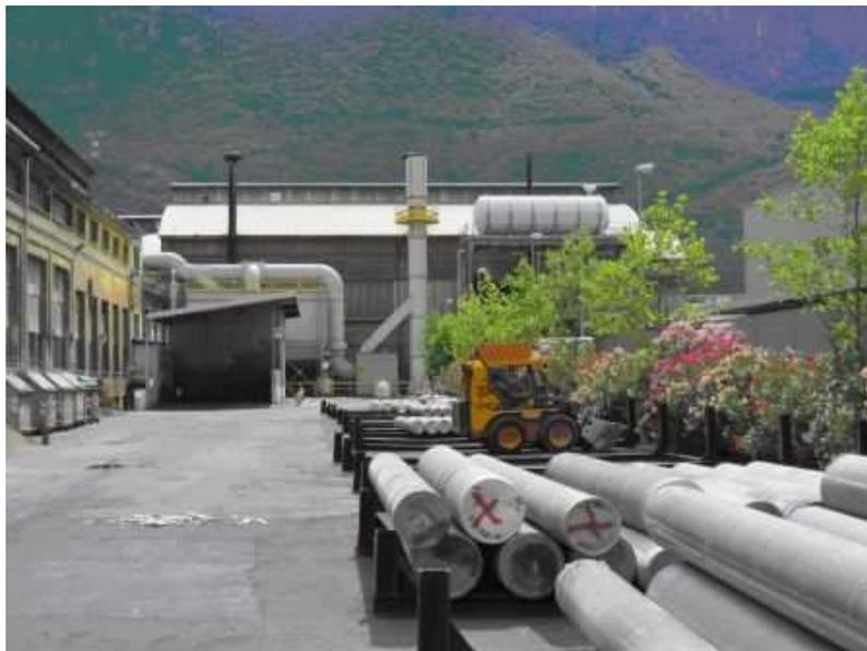
Figura 11: Le billette in attesa di essere lavorate, depositate nel piazzale dello stabilimento. Sullo sfondo il reparto fonderia
