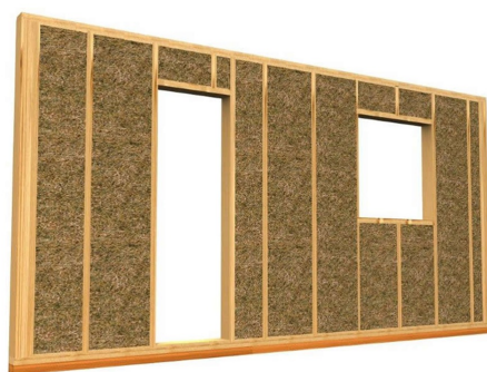
Figura 2.5: Inserimento del materiale isolante all'interno di una parete
