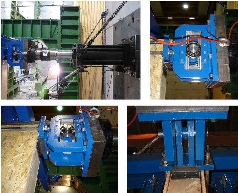
Figura 4.30: Sistema di applicazione carico orizzontale - testa del martinetto
