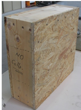
Figura 4.4: Provino per test degli angolari a taglio e particolare di connessione
