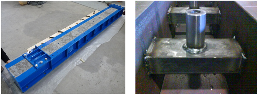
Figura 4.27: Base cls/acciaio - dettaglio interno boccole
