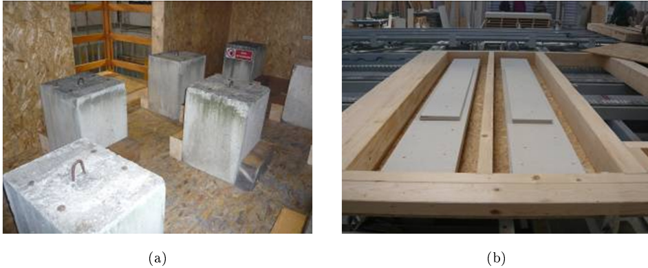
Figura 4.42: Masse aggiuntive sui solai e all'interno delle pareti strutturali
