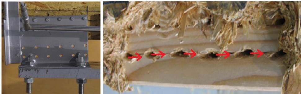
Figura 4.12: Comportamento connessione a taglio puro
