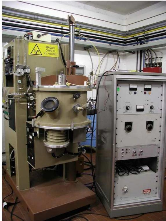
Figura 6.2: Immagine dell'apparato di sputtering Alcatel utilizzato per la deposizione dei campioni.
