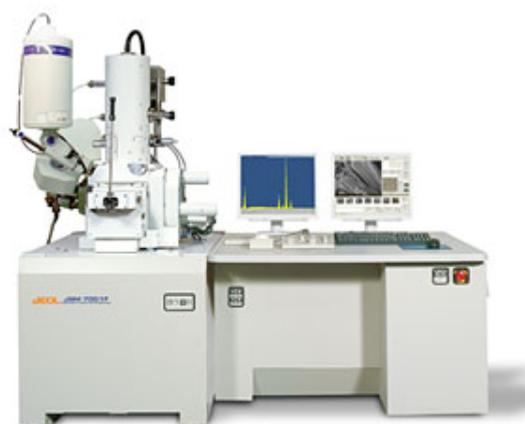
*Figura 6.7: Immagine dello strumento FEG-SEM, corredato del sistema per microanalisi a raggi X (EDS).*
