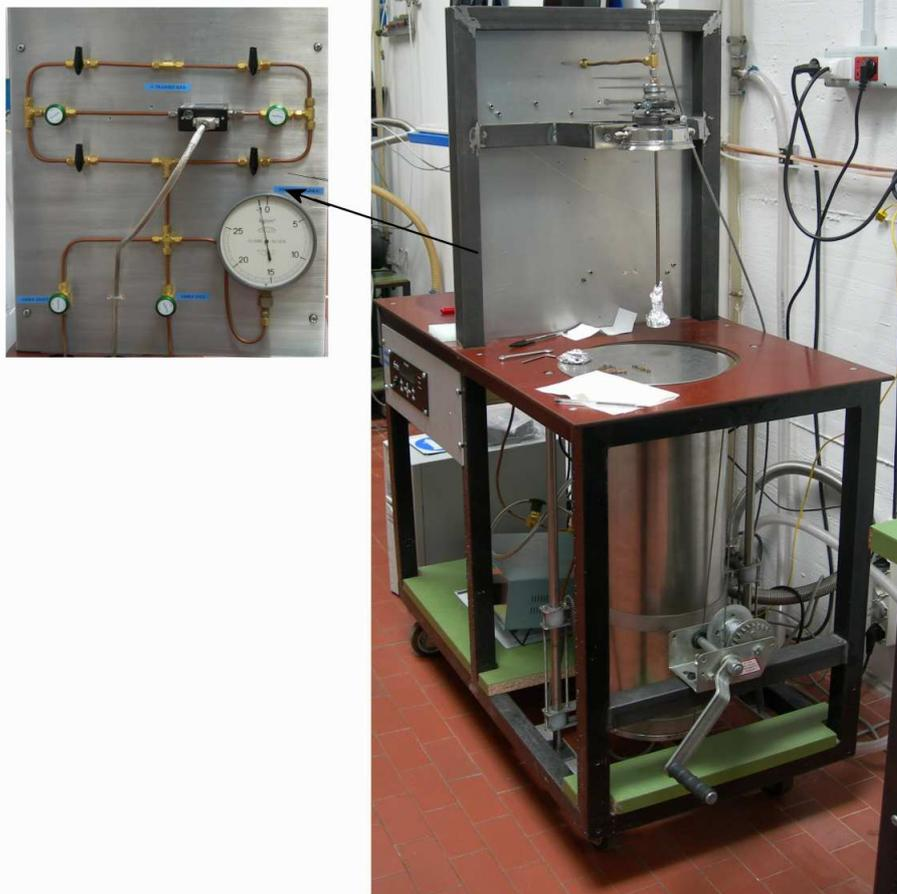
*Figura 6.4: Immagine dell'apparato utilizzato per i trattamenti di assorbimento e desorbimento d'idrogeno. Nel riquadro in alto a sinistra è mostrato il sistema di valvole che consente di regolare l'immissione del gas nella camera e la sua evacuazione.*
