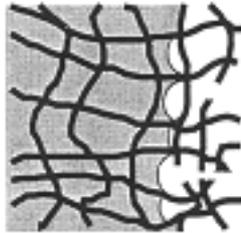
*Figura D.7: Al punto critico il raggio del menisco è uguale al raggio dei pori. La tensione capillare è massima [3].*
