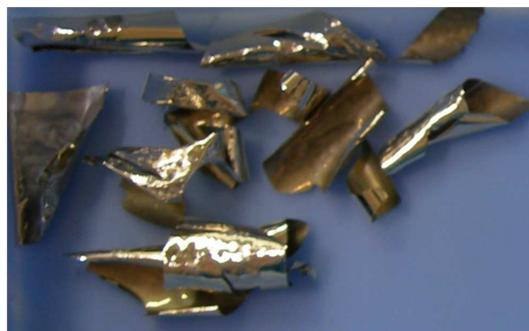
*Figura 6.5: Esempio di campioni di magnesio con lo 0.6% di niobio dopo 4 trattamenti di assorbimento e desorbimento d'idrogeno. Appare evidente la tendenza del materiale ad arrotolarsi su se stesso.*
