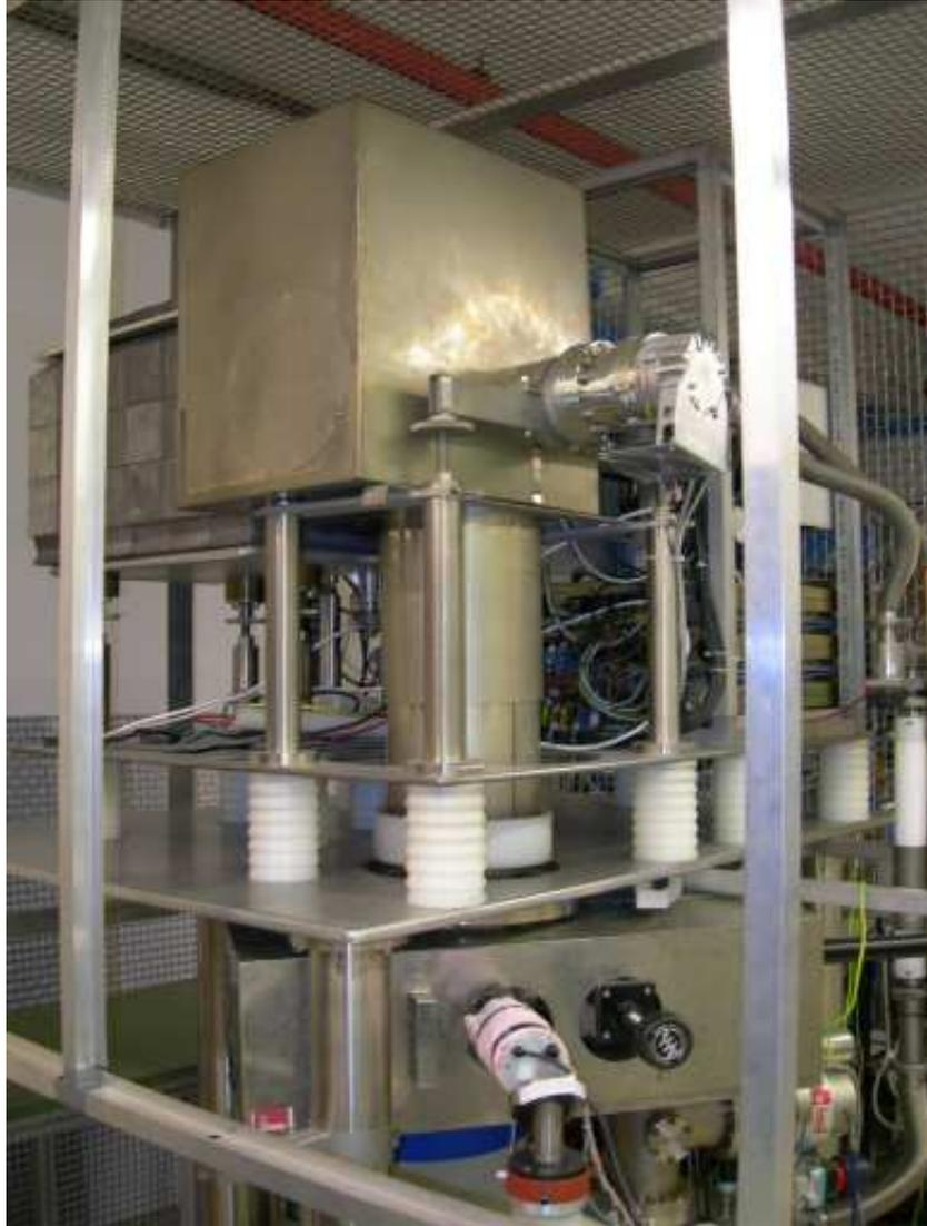
*Figura 3.1: Fotografia dell'apparato per la produzione di fasci di positroni lenti, presente presso i laboratori del Dipartimento di Fisica dell'Università di Trento.*
