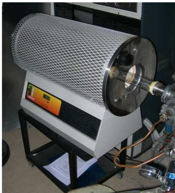
*Figura 5.5: Forno per il trattamento termico dei campioni.*
