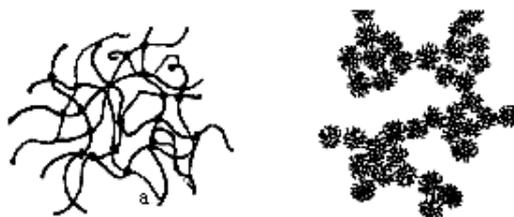
*Figura D.6: Struttura di gel ottenuti per condensazione in ambiente acido (parte sinistra della figura) e basico (parte destra della figura) [3].*
